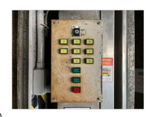
機械が作動している間は操作盤から離れず 非常停止ボタンを押せる位置に必ず留まってください
